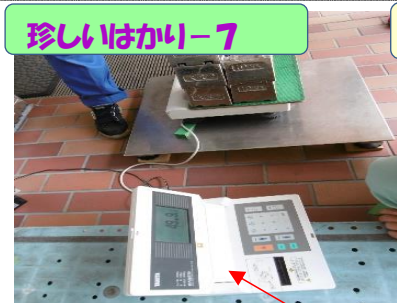
デジタル式体重計(表示器が折りたたみ式)
