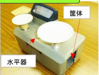
筐体部が破損の為、水平器が不安定
