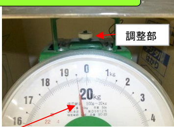
指針の零点調整ができない * 調整部の故障
