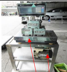
改造品 *台車にはかりとプリンターを設置
